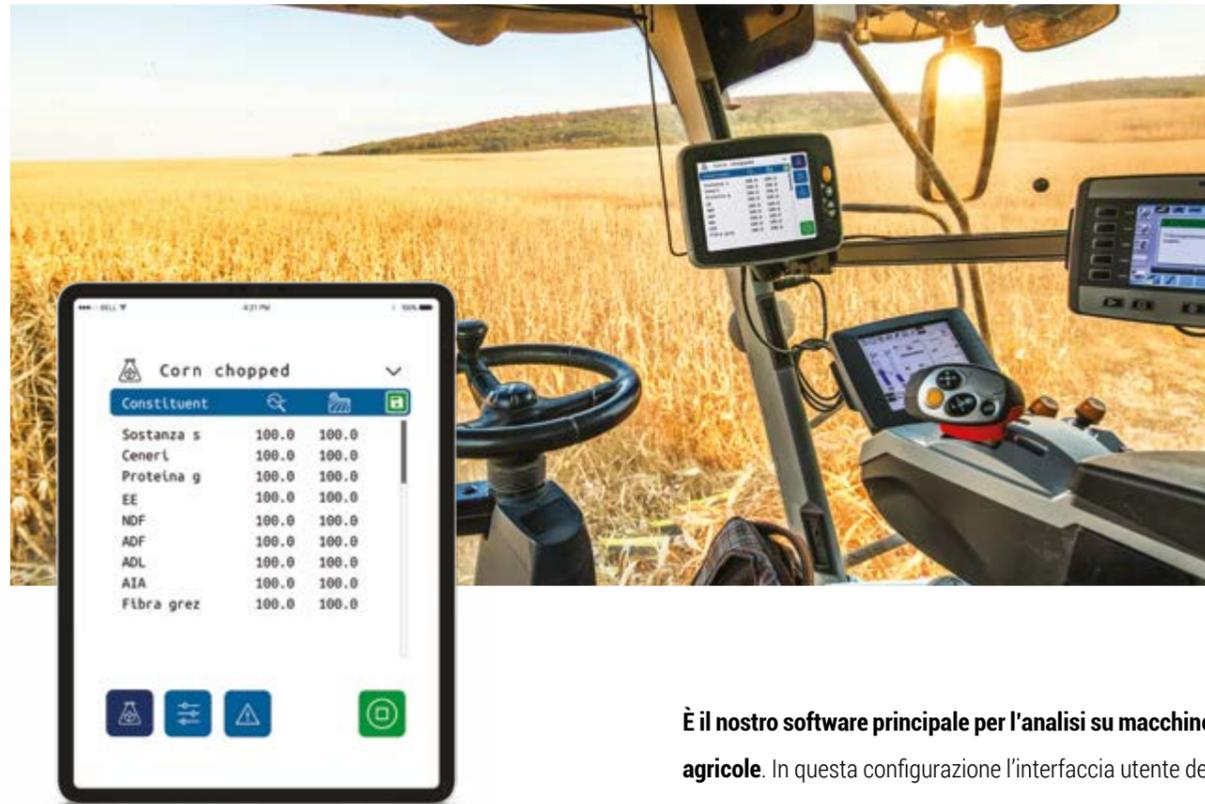
È il nostro software principale per l'analisi su macchine agricole. In questa configurazione l'interfaccia utente del software è disponibile tramite applicazione UT compatibile con tutti i terminali ISObus nativi o applicati.
